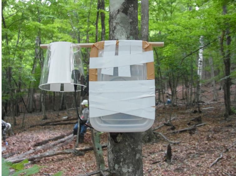
図4. 鳥類の音声を録音するためのボイスレコーダ（プラスチックケースの中）
